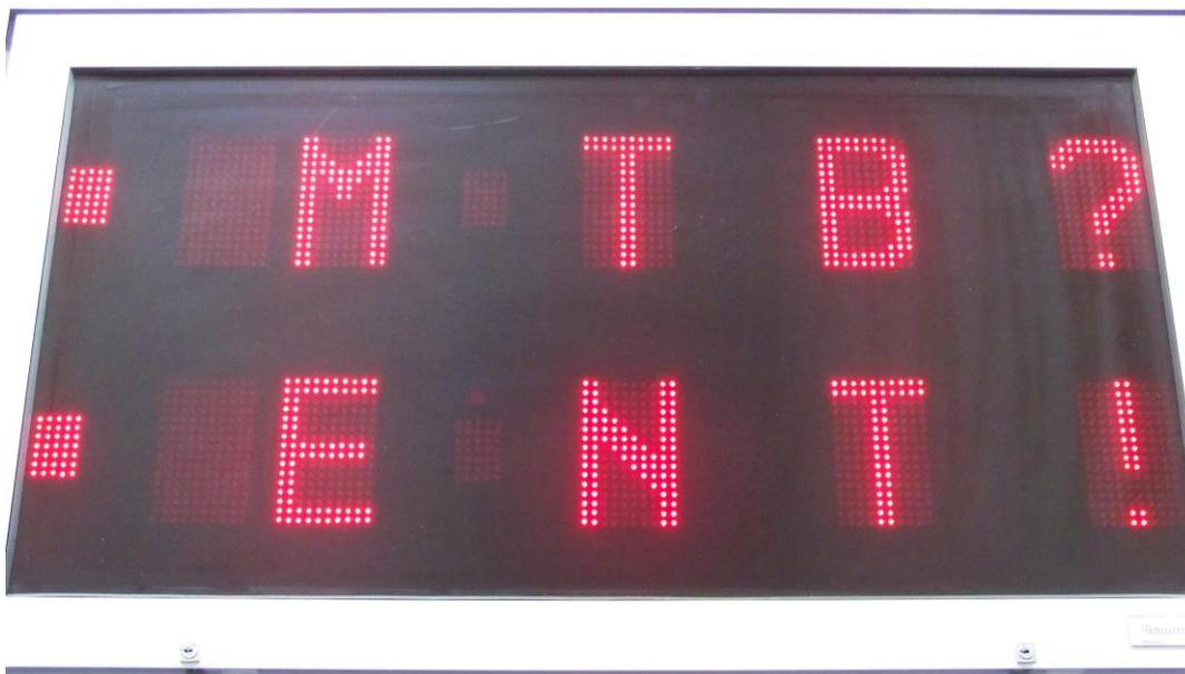
Mit der Taste „ENTER“ wird der Match-Tiebreak-Modus bestätigt und mit Taste „Clear“ wird er abgelehnt und zur herkömmlichen Anzeige eines 3. Satzes übergegangen.
